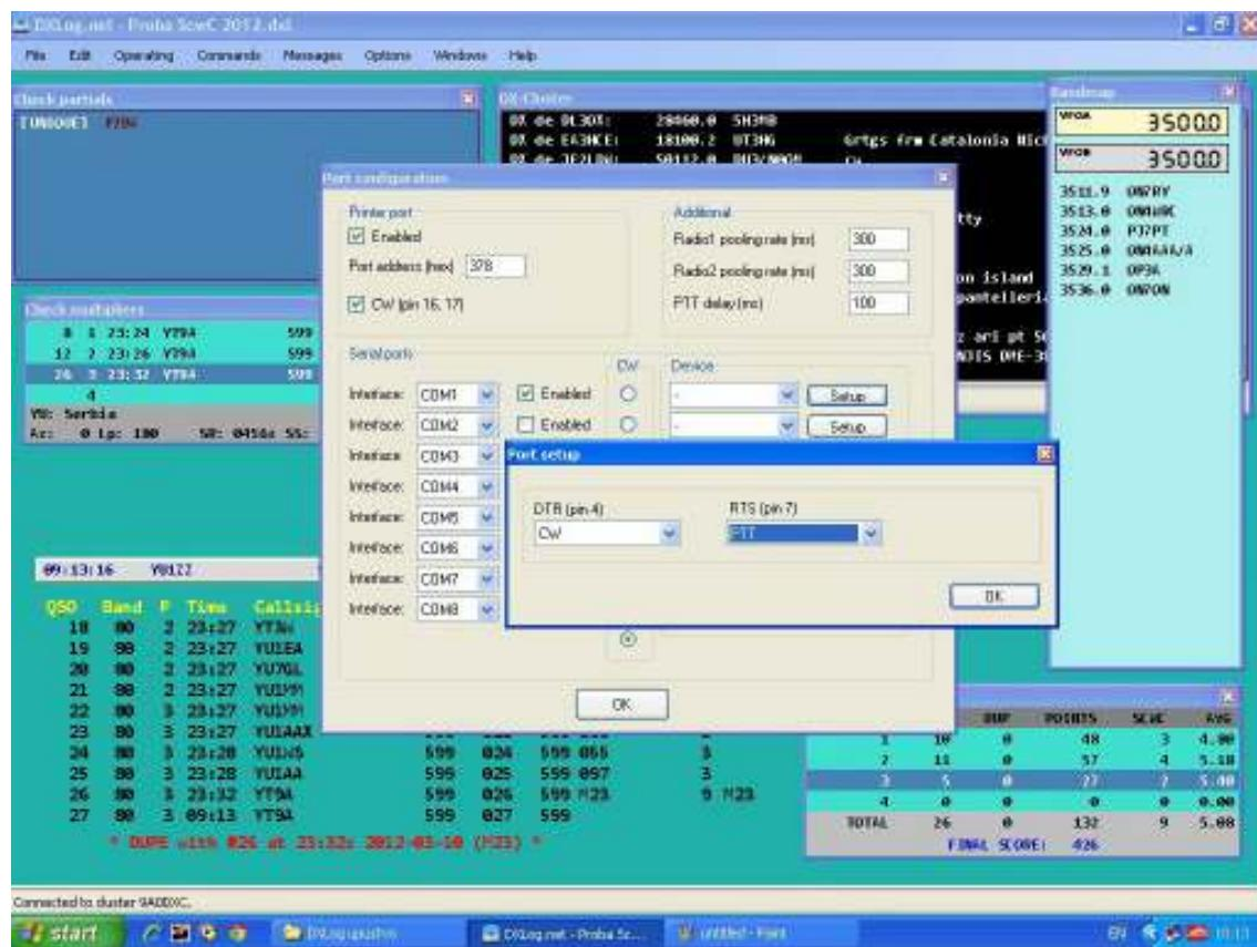
Znaci CW signal izlazi na PIN 4 , PTT na PIN 7 , a masa je PIN 5.
